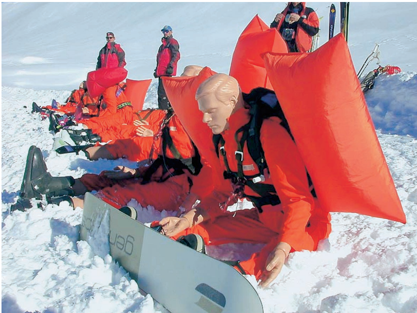
Abb. 2: Versuchspuppe mit Doppelairbag. Großversuch Pitscha-Wäng, 16. März 2001.
